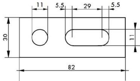
Plaques de support pour vis à double filetage en acier inoxydable A2 de 5 mm d'épaisseur.
