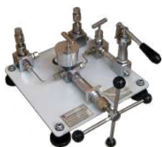
Checking pump Pompe de vérification
